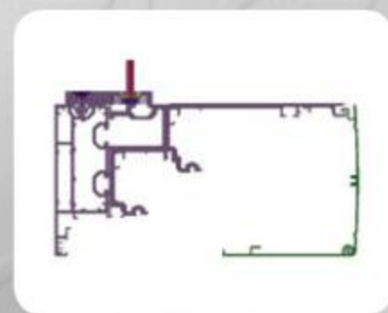
Montaje al techo mediante juego de placas fijadoras.
