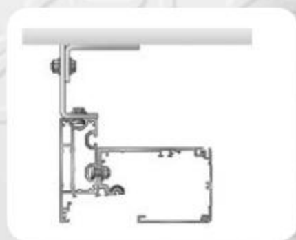
Articulación de escuadras al techo.
