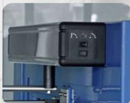
Selector de programas integrado en la unidad FDC "automático/manual/abierto"
